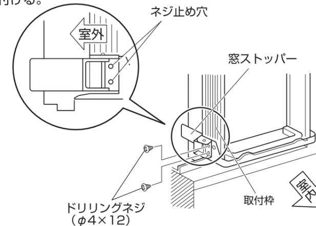
2. 窓ストッパーを倒して、パッキン（戸側）と窓ストッパーの角が当たる部分に切り込みを入れます。
