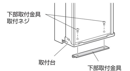
3. 標準取付枠の「取付工事説明書」手順『A.アルミサッシの立ち上がり』にネジ止めできない場合』及び下図をご覧のうえ、枠を取り付けてください。
