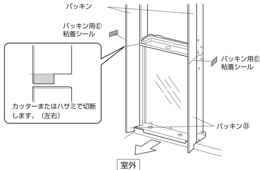
2. 標準取付枠の「取付工事説明書」取付手順3及び下図をご覧のうえ、パッキン（戸側）を切断します。またパッキン戸側と柱側の合わせ部を標準取付枠に付属されている粘着テープで貼り、固定します。
